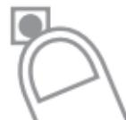
Druk op "Inschakelen" of op "SOS" op het bedieningspaneel (niet op de afstandsbediening). U hoort korte piepjessies: de sirene is nu verbonden met het bedieningspaneel.
