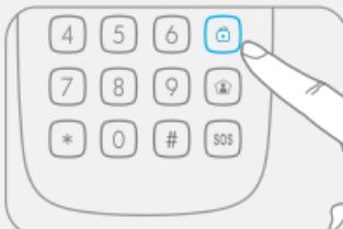
Когда панель управления получает сигнал, сирена дважды издает гудок, и загорается индикатор отключения: это свидетельствует об успешном выключении системы сигнализации.
