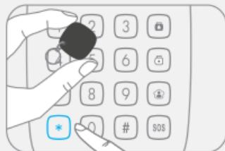
El lector RFID se desactiva al pasar un dispositivo RFID frente al lector RFID, al pulsar de nuevo el botón [\*] en el teclado, o transcurridos 10 segundos sin realizar ninguna acción.
