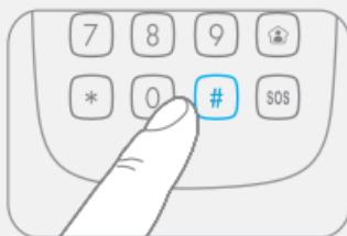
В режиме настройки, если в течение 30 секунд не производятся никакие действия, клавиатура автоматически выходит из режима настройки. Также для выхода из режима настройки можно нажать клавишу [\*].
