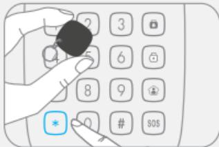
Il lettore RFID si disattiva quando un tag RFID viene passato davanti al lettore RFID, quando viene premuto di nuovo il tasto [\*] sul tastierino, o dopo 10 secondi senza operazioni.
