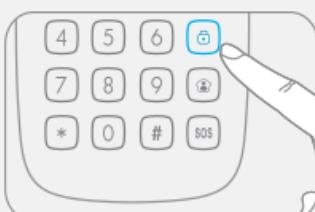
Cuando el panel de control recibe la señal, la sirena emite dos pitidos y se enciende el indicador de desarmado para señalar que el sistema de alarma está ahora desarmado.
