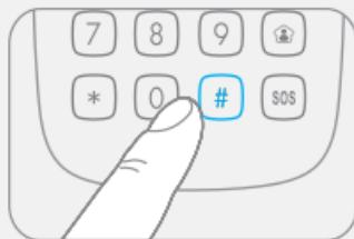
*En mode Paramétrage, si aucune opération n'est effectuée pendant 30 secondes, le clavier quitte le mode Paramétrage automatiquement. Vous pouvez également quitter le mode Paramétrage en appuyant sur la touche [\*] du clavier.*
