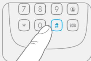
*En el modo de Configuración, si no realiza ninguna acción en un periodo de 30 segundos el teclado saldrá automáticamente del modo de Configuración. También puede salir del modo de Configuración pulsando [\*].*
