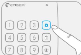
После поступления сигнала на панель управления сирена издаст один звуковой сигнал, и загорится индикатор включения системы на панели управления. Теперь охранная система включена.
