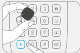
De RFID-lezer wordt uitgeschakeld wanneer een RFID-tag voor de lezer langs wordt geveegd, wanneer nogmaals op de knop [\*] op de keypad wordt gedrukt of nadat 10 seconden lang geen handelingen zijn uitgevoerd.
