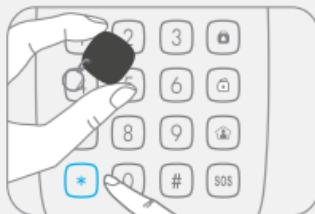
Считыватель радиочастотных меток выключается при проведении перед ним RFID-тегом, при повторном нажатии на клавиатуре клавиши [\*] или по истечении 10 секунд бездействия.
