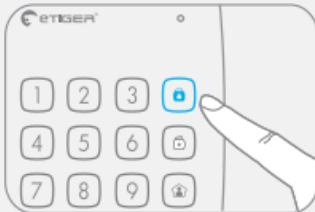
Quando il pannello di allarme riceve il segnale, la sirena emette un segnale acustico e la spia Arma sul pannello di comando si accende. Il sistema di allarme è ora armato.
