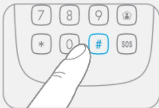
*Wanneer in de configuratiemodus 30 seconden lang geen handelingen worden uitgevoerd, dan sluit de keypad deze modus automatisch af. U kunt de configuratiemodus ook afsluiten door op [\*] te drukken.*
