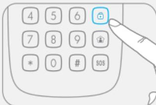
Lorsque la centrale reçoit le signal, la sirène émet deux bips et le témoin lumineux de la centrale s'allume, indiquant que le système est désarmé.
