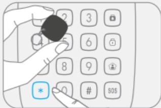
Das RFID-Lesegerät schaltet sich aus, sobald ein RFID-Tag über die Vorderseite des RFID-Lesegeräts gewischt oder die Taste [\*] erneut auf der Tastatur gedrückt wird oder nach 10 Sekunden ohne Bedienung.
