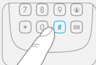
In modalità Impostazioni, se non viene effettuata alcuna operazione per 30 secondi, il tastierino uscirà automaticamente dalla modalità. È possibile uscire dalla modalità Impostazioni anche premendo [\*].
