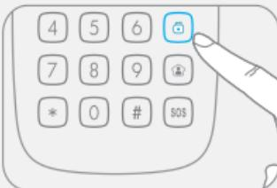
Wanneer het bedieningspaneel het signaal ontvangt, geeft de sirene twee piepjes af en gaat het uitschakellampje branden: het alarmsysteem is nu uitgeschakeld.
